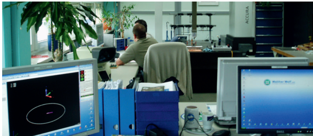
Messraum: Mitarbeiter diskutieren die Ergebnisse der Qualitätssicherung, welche die Koordinatenmessmaschine und das Video-Check-System ermittelt haben. Vermessen werden Teile von 1 bis 1400 mm tastend, optisch und per Laser.
