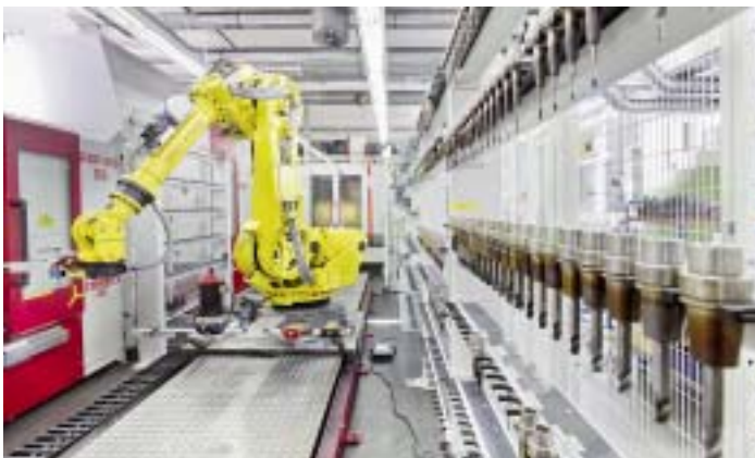
Ein Roboter verkettet vier Fräszentren für die Elektrodenbearbeitung. Das Regal bietet Roh- und Fertigelektroden sowie Fräswerkzeugen Platz Bild: Hofmann
