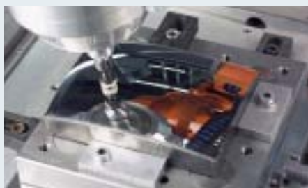
Bald sollen Roboter große Freiformflächen spiegelblank polieren Bild: IPT
