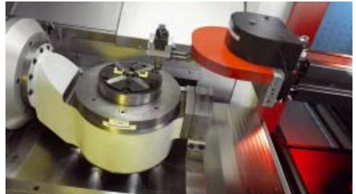
Ein Handlingsystem entnimmt die fertig gefrästen Elektroden aus dem 5-achsigen Bearbeitungszentrum RXP500 von Röders Bilder: Walther Wolf
