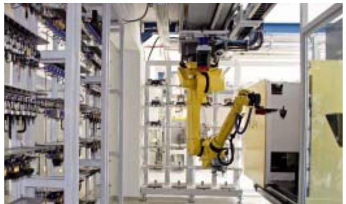
Besonderheit der Lösung von Werkzeugbau Ruhla: Der Roboter ist an der Decke geführt, der Boden barrierefrei, die Maschine gut zugänglich Bild: Ruhla
